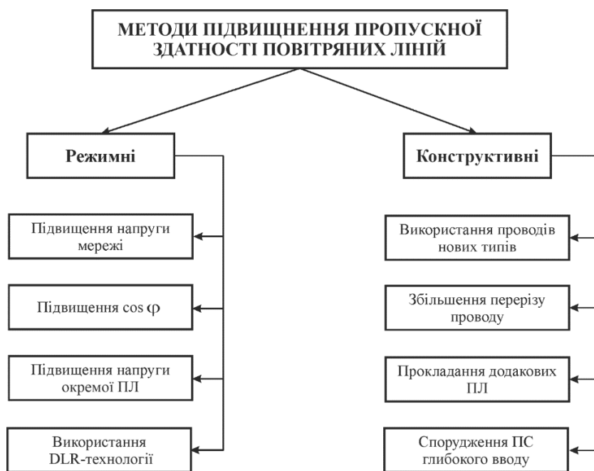
Рисунок 1 – Способи підвищення пропускної здатності ПЛ
