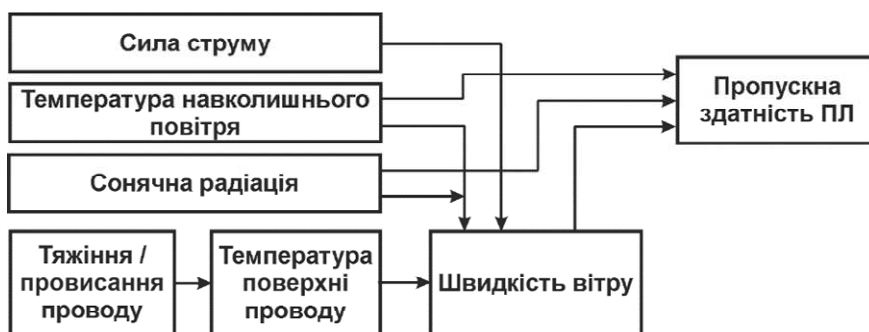
Рисунок 3 – Реалізація підходу DLR: «Тяжіння проводу та метеорологічні параметри»
